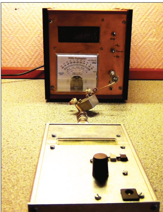
Foto 2. Måleopstillingen med krystalfilteret
