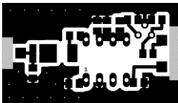
Figur 9. Printudlæg til proben. printet er 19 X 32 mm.
