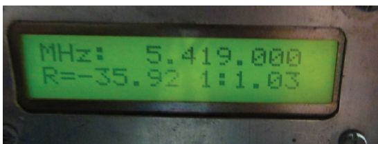
Fig. 16. Måling på min 60 meter dipol med VSWR-meteret fra OZ juni 2016
